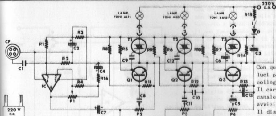
Con questo KIT si realizza un ottimo impianto di luci psichedeliche senza dover effettuare alcun collegamento con la sorgente sonora. Il carico massimo applicabile è di 1500 W per canale. Per il suo funzionamento occorre soltanto avvicinarlo alla fonte sonora.
